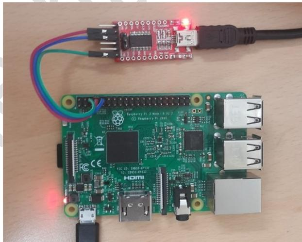
시리얼 포트를 연결할 때, GND는 GND, 전원이 필요할 경우 VCC는 VCC에 연결(3.3V인지 5V)인지 주의해서)하면 됩니다. 또한 송신과 수신은 TX, RX를 혼동하기 쉽습니다. 라즈베리파이의 TX는 라즈베리파이가 신호를 보내는 선이니, 컨버터의 RX에 연결하여야 합니다. 마찬가지로 라즈베리파이의 RX는 라즈베리파이가 신호를 받는 선이니, 컨버터의 TX에 연결하여야 합니다. 라즈베리파
